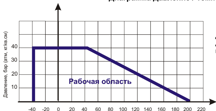
Диаграмма Давление / Температура для шарового крана ABRA-BV-027A
