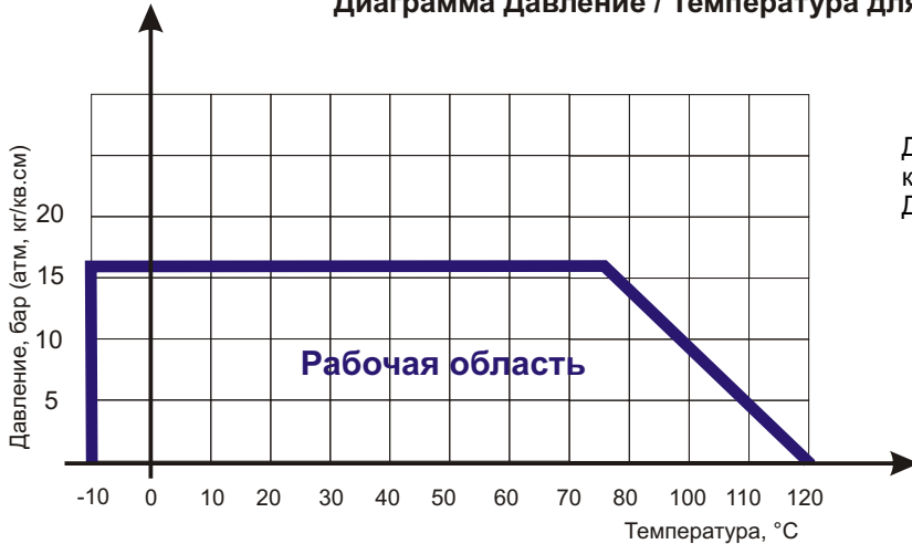
Диаграмма Давление / Температура для клапана обратного ABRA-D-122
