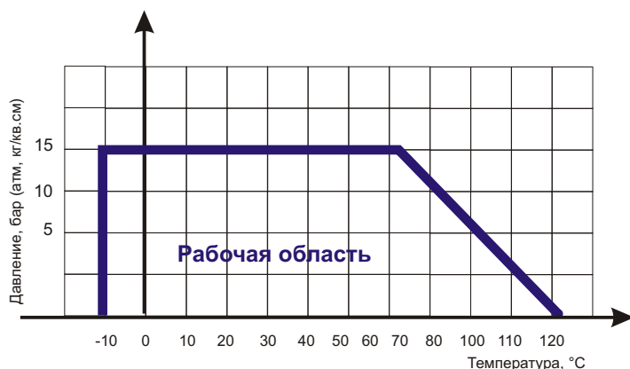
Диаграмма Давление / Температура для задвижки клиновой ABRA-A40-16-XXXG с обрезиненным клином и невыедным штоком Ду 300-900, Ру 16
