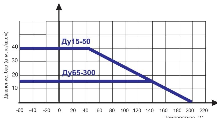
Диаграмма определяет рабочую область для шарового крана фланцевого ABRA-BV41 в координатах Давление (в барах приборного) / Температура (° С).
