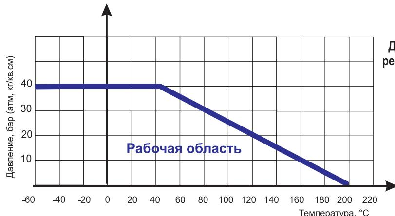
Диаграмма определяет рабочую область для шарового крана резьбового ("муфтового") ABRA-BV61A в координатах Давление (в барах приборного) / Температура (° С).
