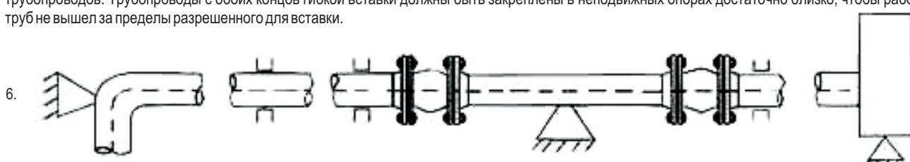
6. Гибкие вставки следует устанавливать непосредственно за неподвижной опорой. За гибкой вставкой следует предусмотреть подвижные опоры.
