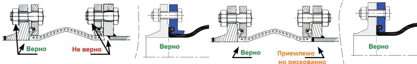
19. Обратите внимание на правильный подбор и подготовку фланцев к монтажу гибкой вставки (вибровставки) - виброкомпенсатора. Очень важным является использование динамометрического ключа. Моменты затяжки и последовательность операций см. ниже.
