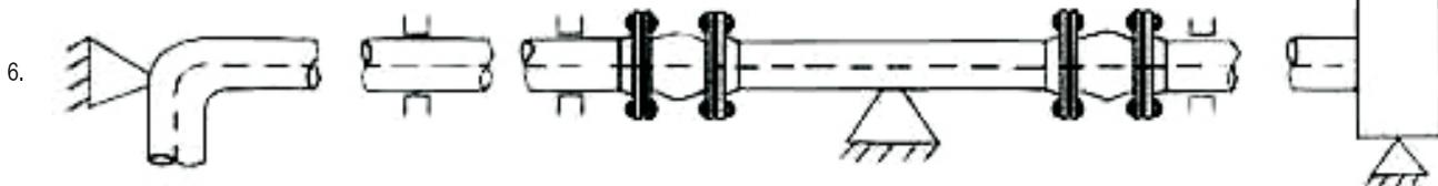
7. Гибкие вставки следует устанавливать непосредственно за неподвижной опорой. За гибкой вставкой следует предусмотреть подвижные опоры.
