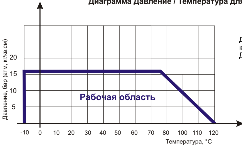
Диаграмма Давление / Температура для клапана обратного ABRA-D-122
