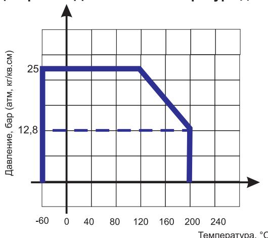
Диаграмма определяет рабочую область для обратного клапана тарельчатого межфланцевого ABRA-D71 в координатах Давление (в барах приборного) / Температура (° С).
