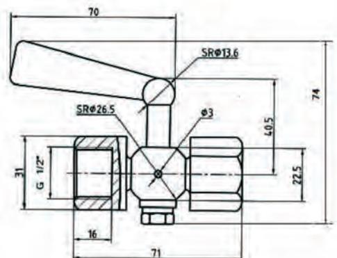
Габаритные размеры в мм крана трехходового под манометр ABRA KM VFM резьбового (клапана к манометру).
